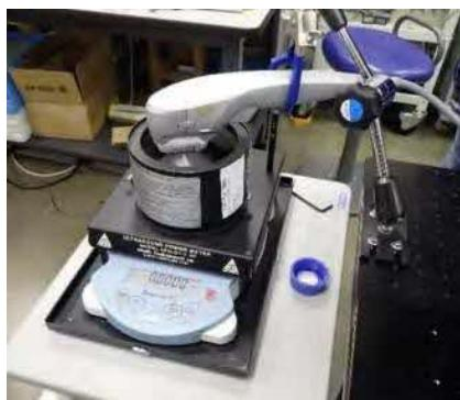
写真C 1 超音波パワーメータ
