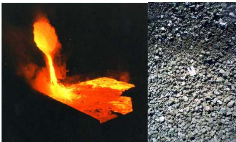
【溶融炉からの出 しゅっさい 滓状況】
