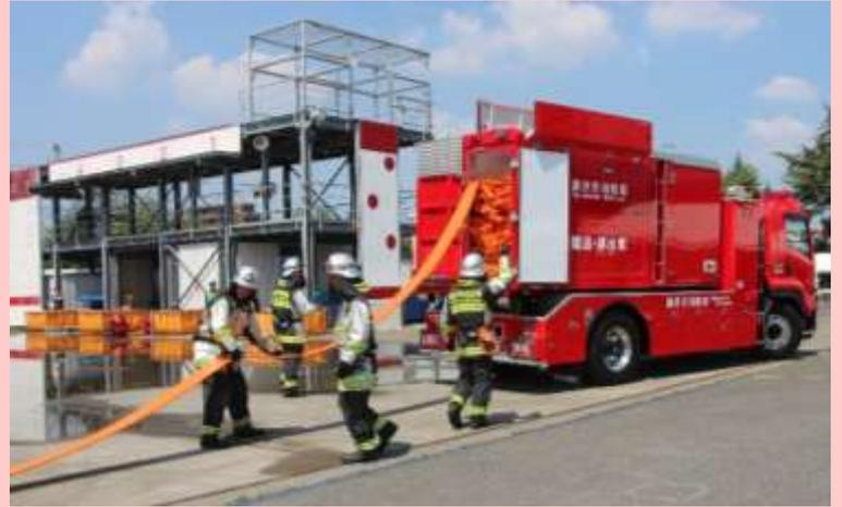
遠距離送・排水システム車は150ミリの大口径ホースを積載しており、自然水利を活用して、1キロメートル先まで送水できるほか、大型の排水専用ポンプにより短時間で大量の排水が可能な車両です。今回の訓練では送水のためにホースを延ばし、専用の分水器を用いて5口から放水をしました！
