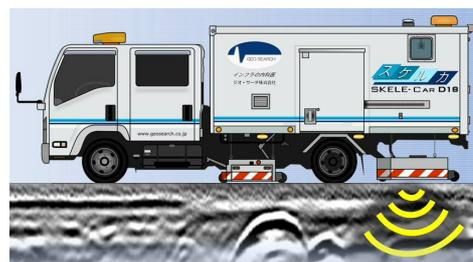
図-3 空洞探査車と取得データ例
