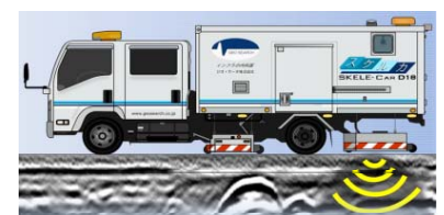
図-1 空洞探査車と取得データ例
