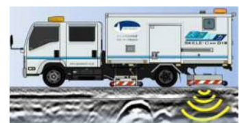
図-1 空洞探査車と取得データ例
