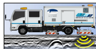
図-1 空洞探査車と取得データ例
