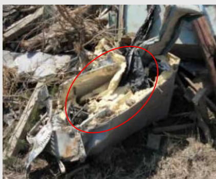
図 津波等により流失した断熱材
