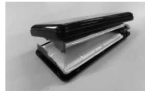
膨張したリチウムイオン電池
