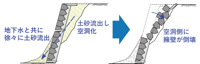
(3) 背面側の土砂の流出
