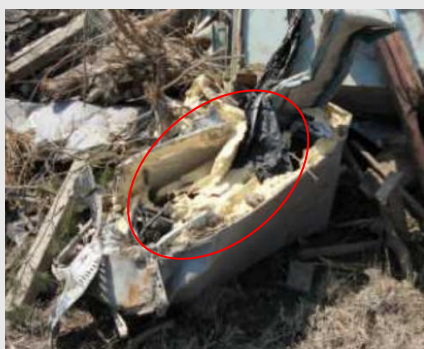
図 津波等により流失した断熱材
