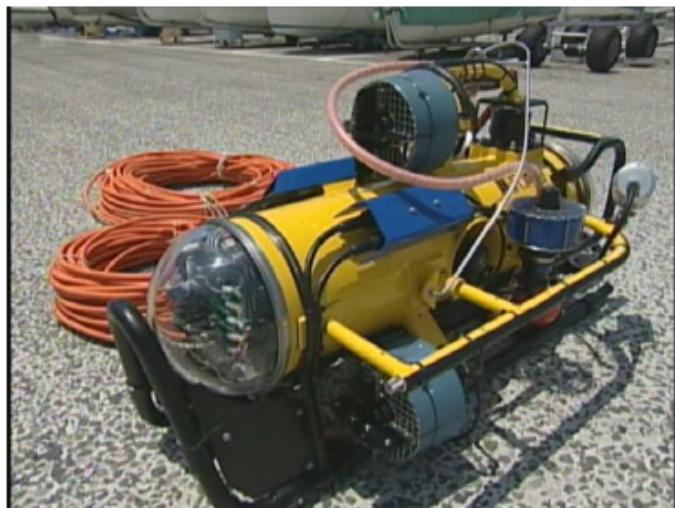
スクリューで 水中 を 自由 に 移動 できるハイテクロボット。水 中の様子が陸上で見られるよ。
